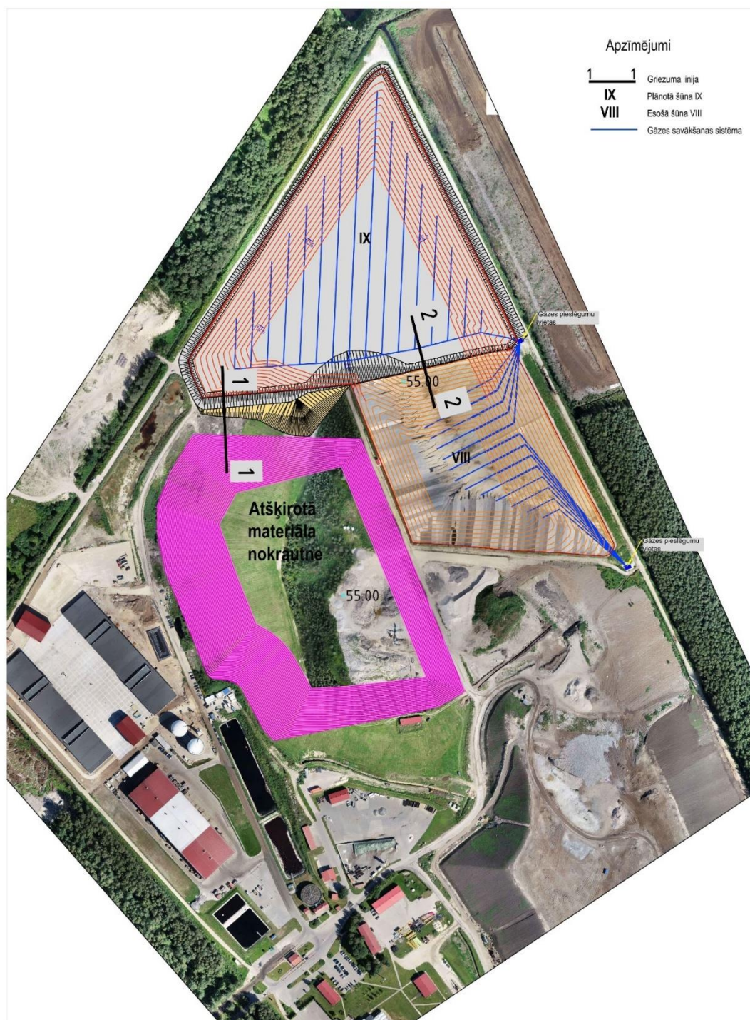
3.39. attēls. Būvniecības darbu 3. kārta: Atkritumu aizpildīšana un gāzes savākšanas sistēmas izbūve šūnā Nr. IX un šūnā Nr. VIII
