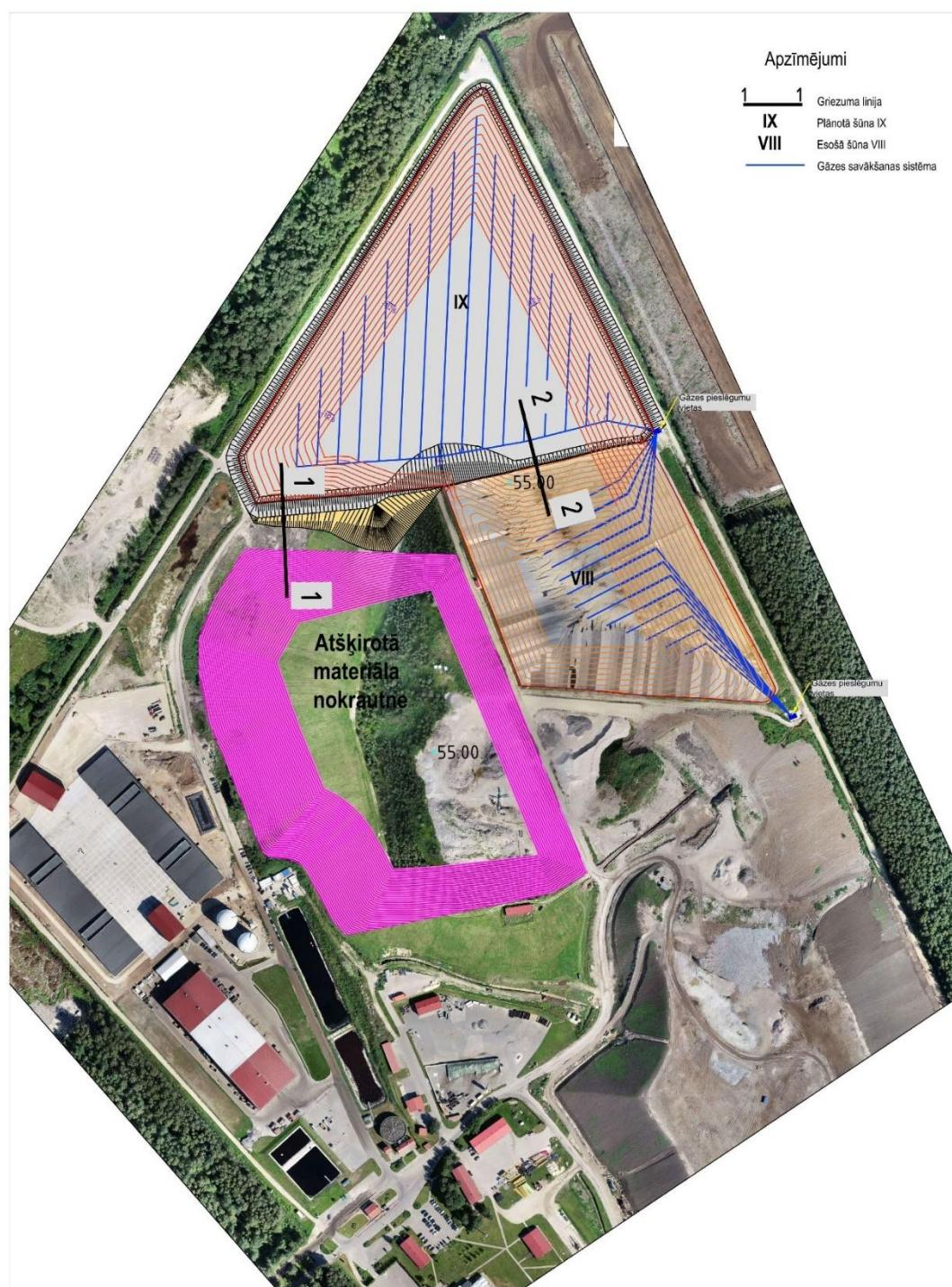
**8.attēls. Būvniecības darbu 3. kārta: Atkritumu aizpildīšana un gāzes savākšanas sistēmas izbūve šūnā Nr. IX un šūnā Nr. VIII**
