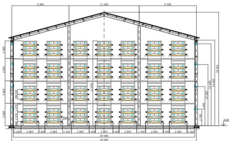
3.10. attēls. Dējējvistu turēšanas novietnes šķērsriezuma profils
