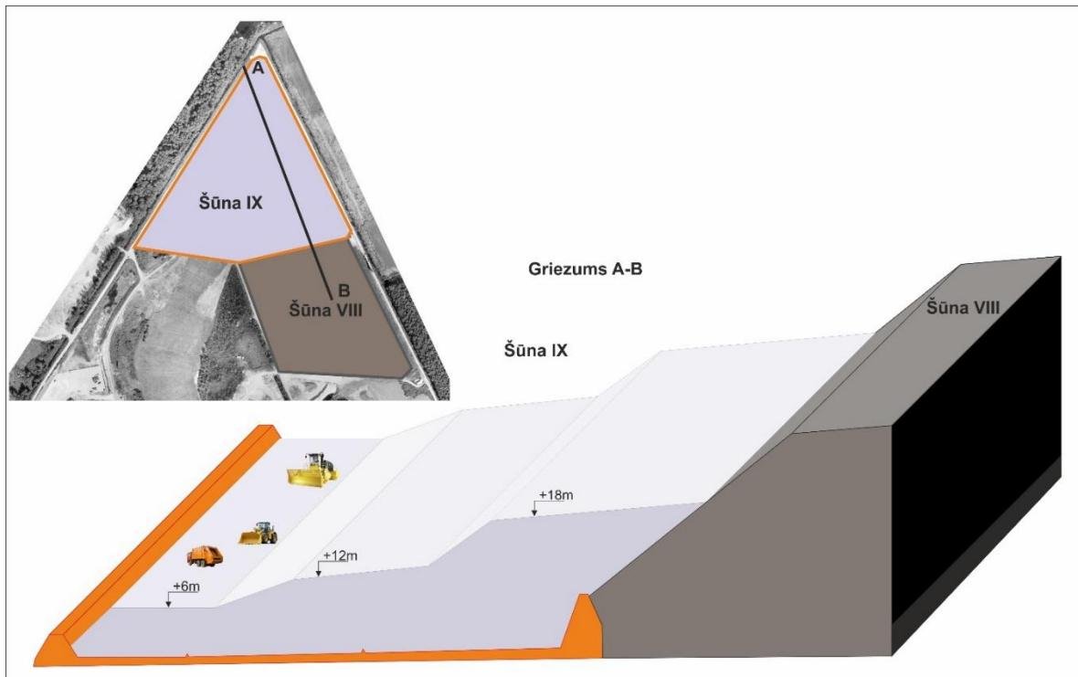
3.45. attēls. Šūnu aizpildīšanas (ekspluatācijas) tehnoloģiskā shēma
