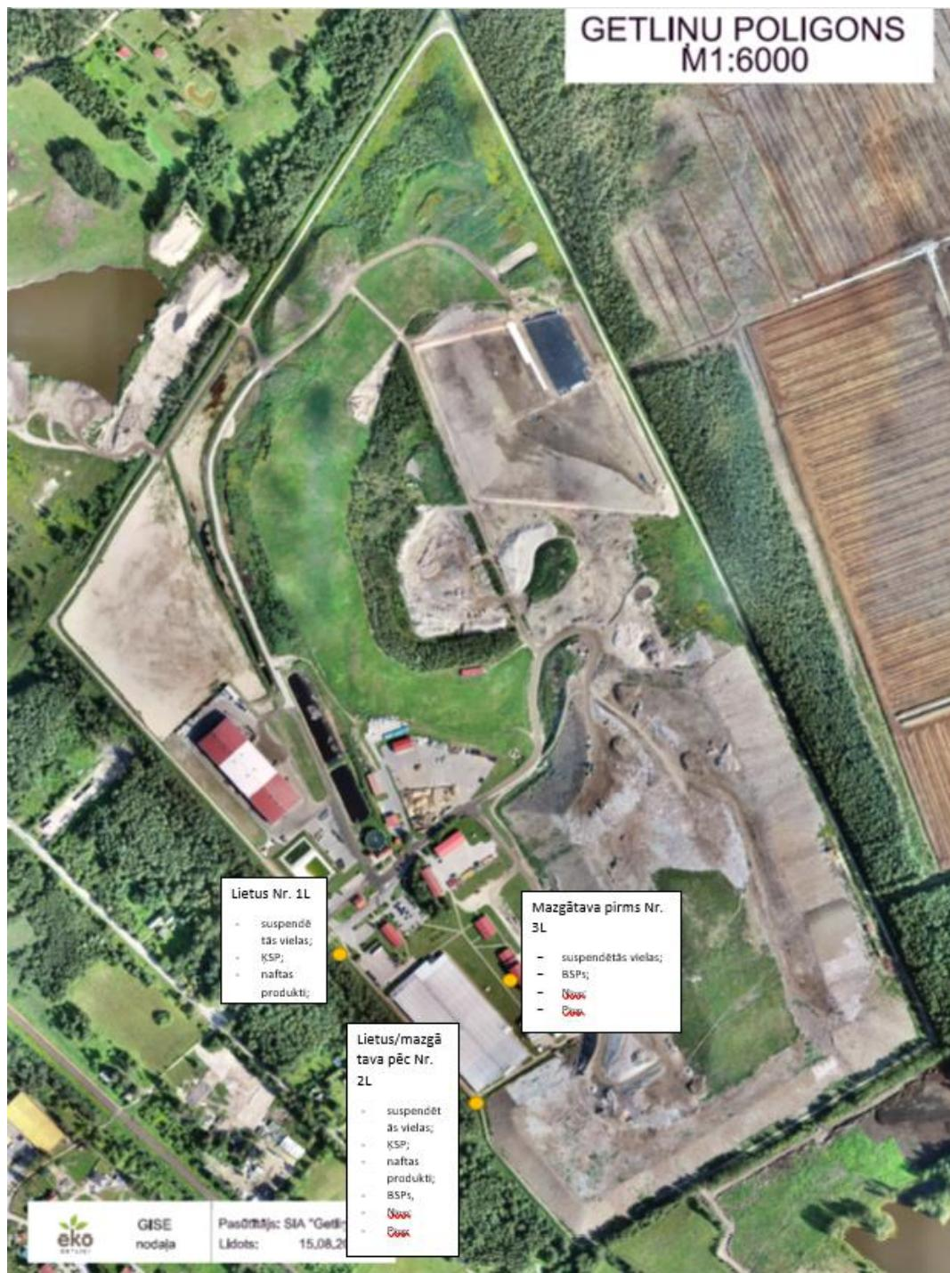
13.4. attēls. Notekūdeņu paraugošanas punktu izvietojums
