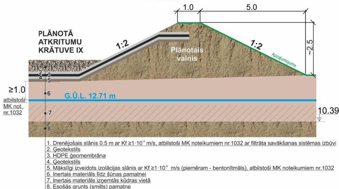
4.3. attēls. 1. alternatīvas un 2. alternatīvas atkritumu apglabāšanas šūnas Nr. IX uzbūve (shematisks zīmējums)
