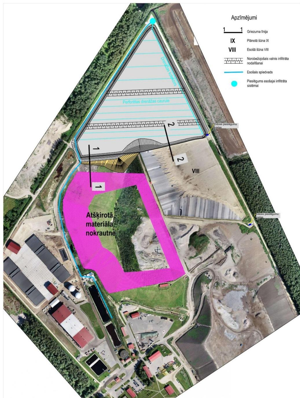
3.40. attēls. Būvniecības darbu 2. kārta: krātuves konstrukcijas un valņu izveidošana, infiltrāta sistēmas izveide
