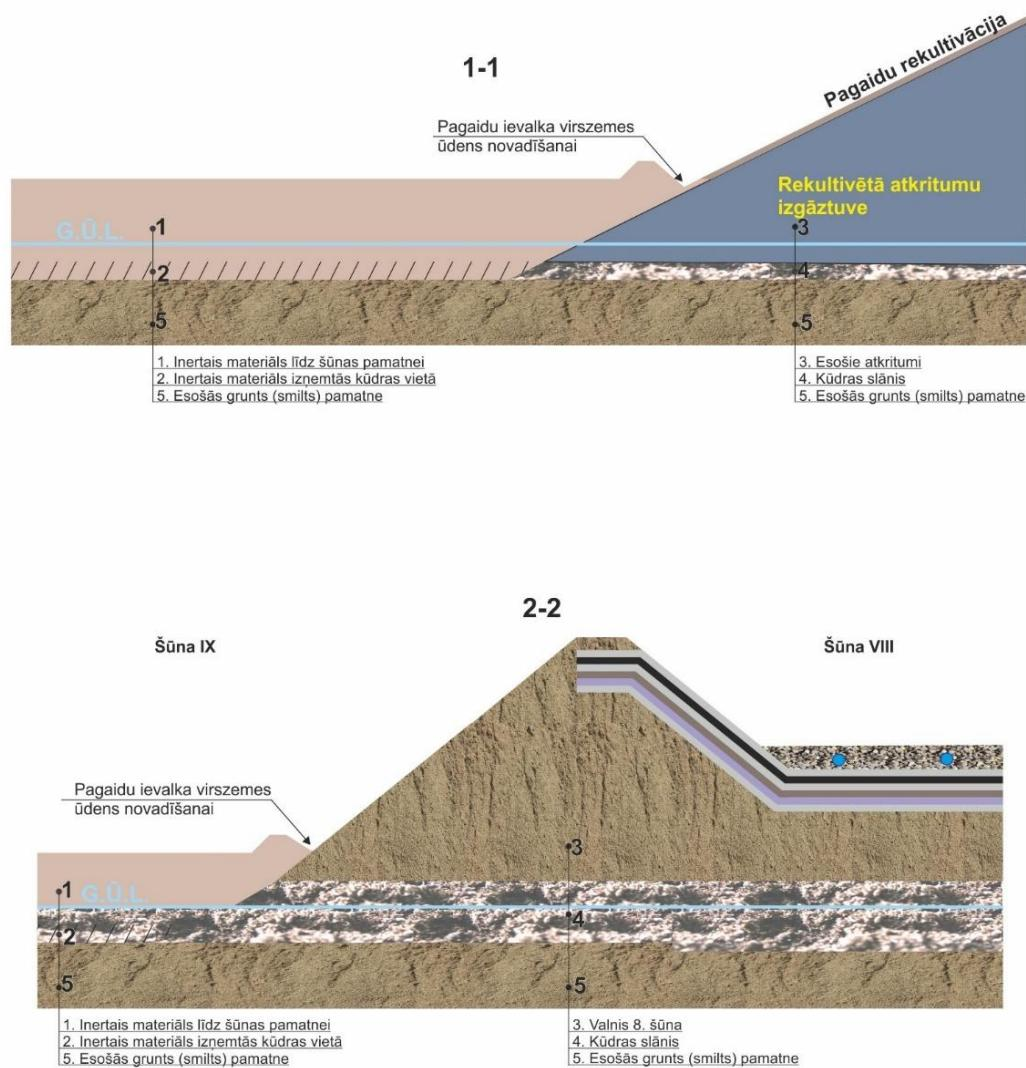
**3.35. attēls. Būvniecības darbu 1. kārta: rekultivācijas pārklājošā slāņa izņemšana, atkritumu izņemšana un inertās kārtas ievietošana. 1-1 griezums un 2-2 griezums**
