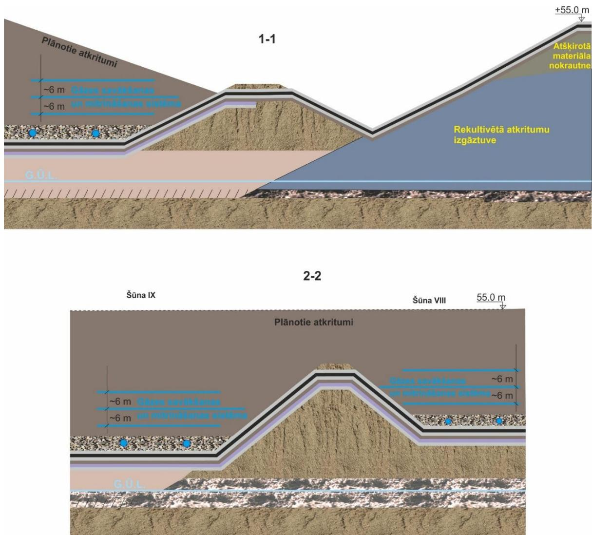
3.44. attēls. Būvniecības darbu 3. kārta: Atkritumu aizpildīšana un gāzes savākšanas sistēmas izbūve šūnā Nr. IX un šūnā Nr. VIII. 1-1 griezums un 2-2 griezums
