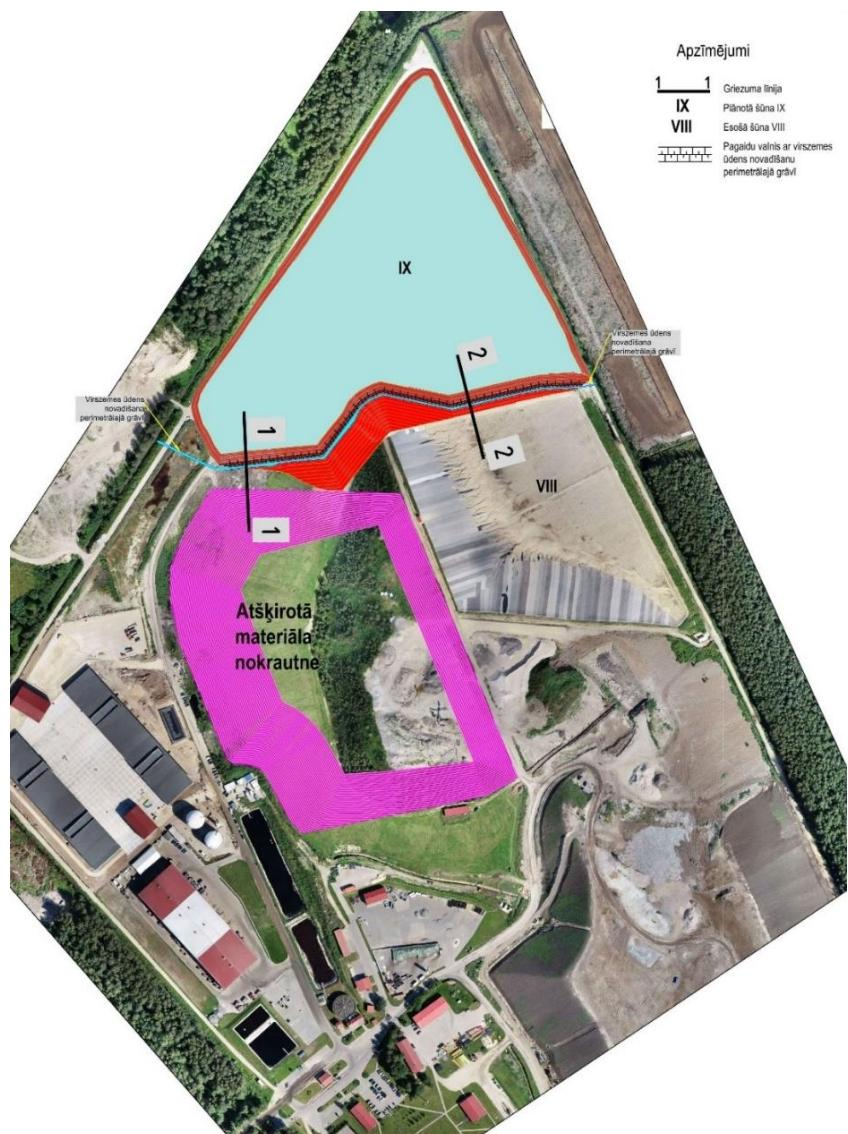
3.34. attēls. Būvniecības darbu 1. kārta: rekultivācijas pārklājošā slāņa izņemšana, atkritumu izņemšana un inertās kārtas ievietošana, 1-1 griezuma un 2-2 griezuma izvietojums
