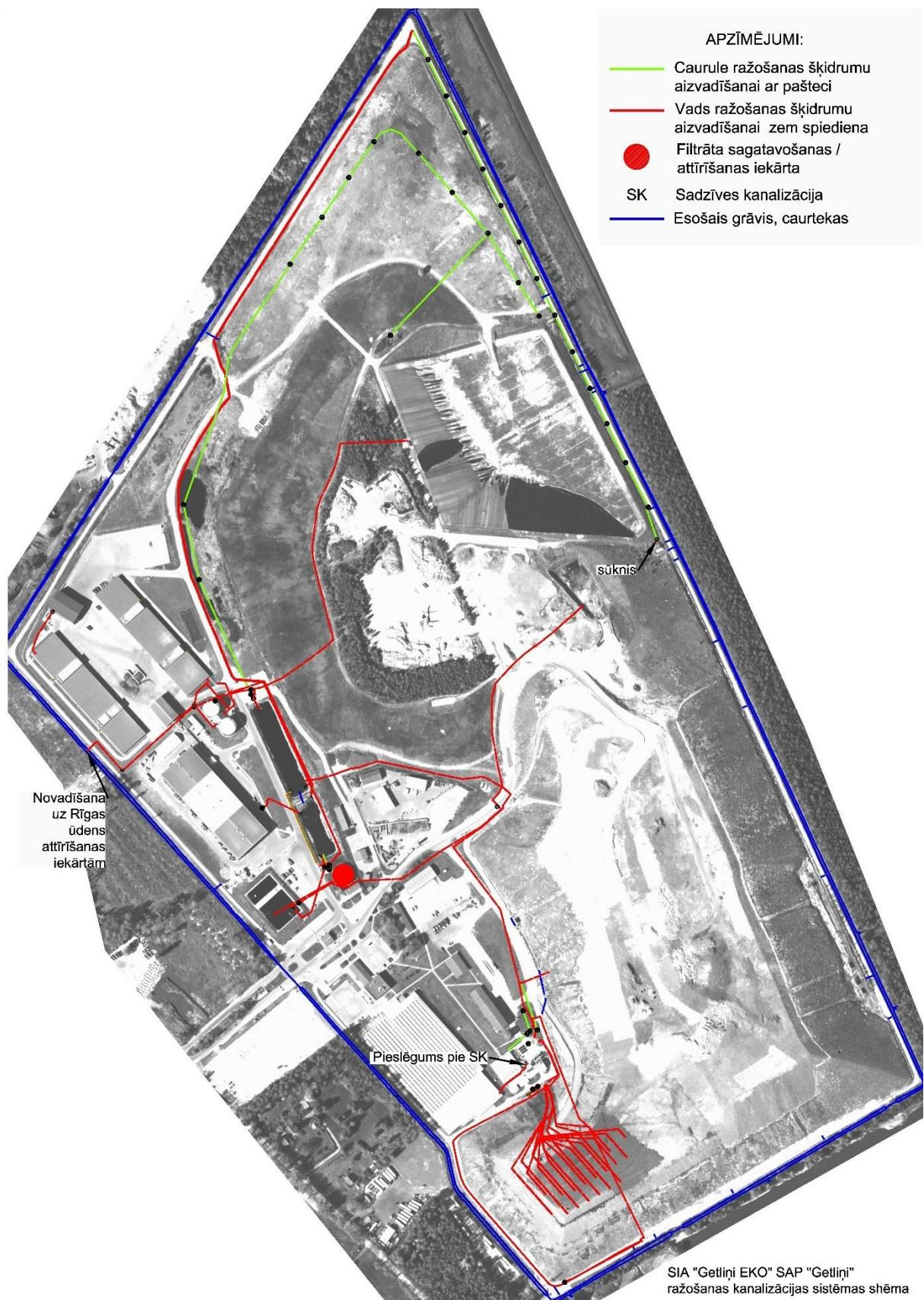
3.11. attēls. Sadzīves atkritumu poligona "Getliņi" ražošanas kanalizācijas sistēmas shēma
