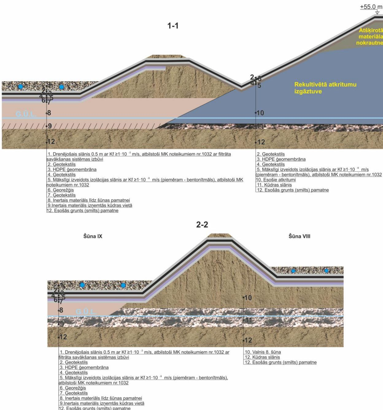
3.41. attēls. Būvniecības darbu 2. kārtai: krātuves konstrukcijas un valņu izveidošana, infiltrāta sistēmas izveide. 1-1 griezums un 2-2 griezums
