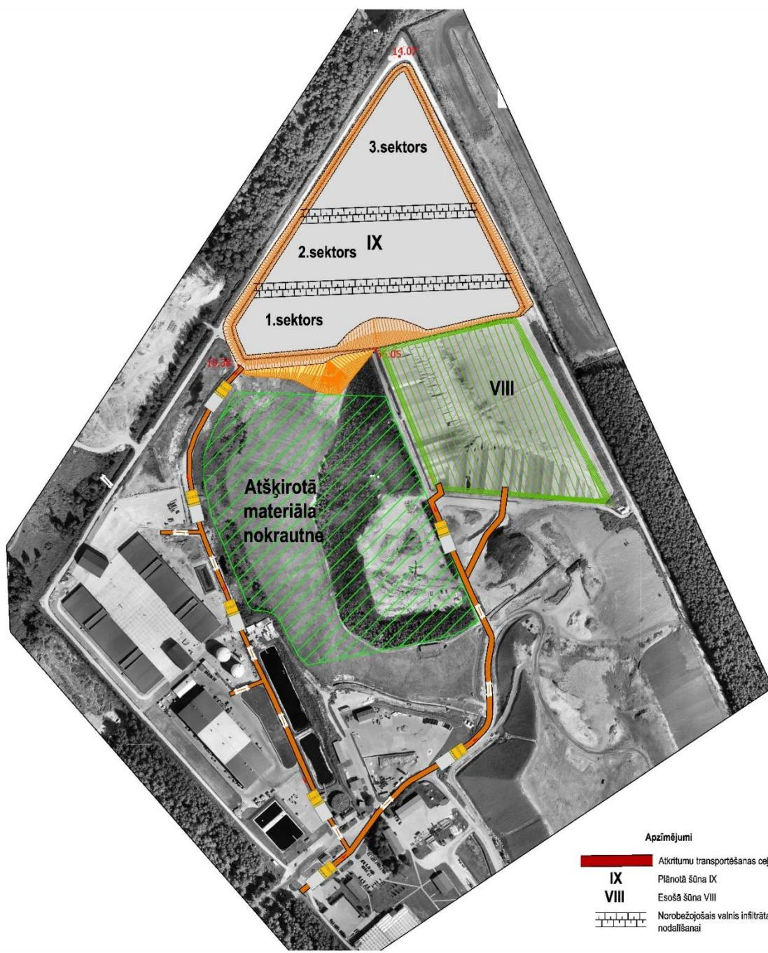
3.49. attēls. Ceļu izvietojums šūnu piepildīšanas periodā
