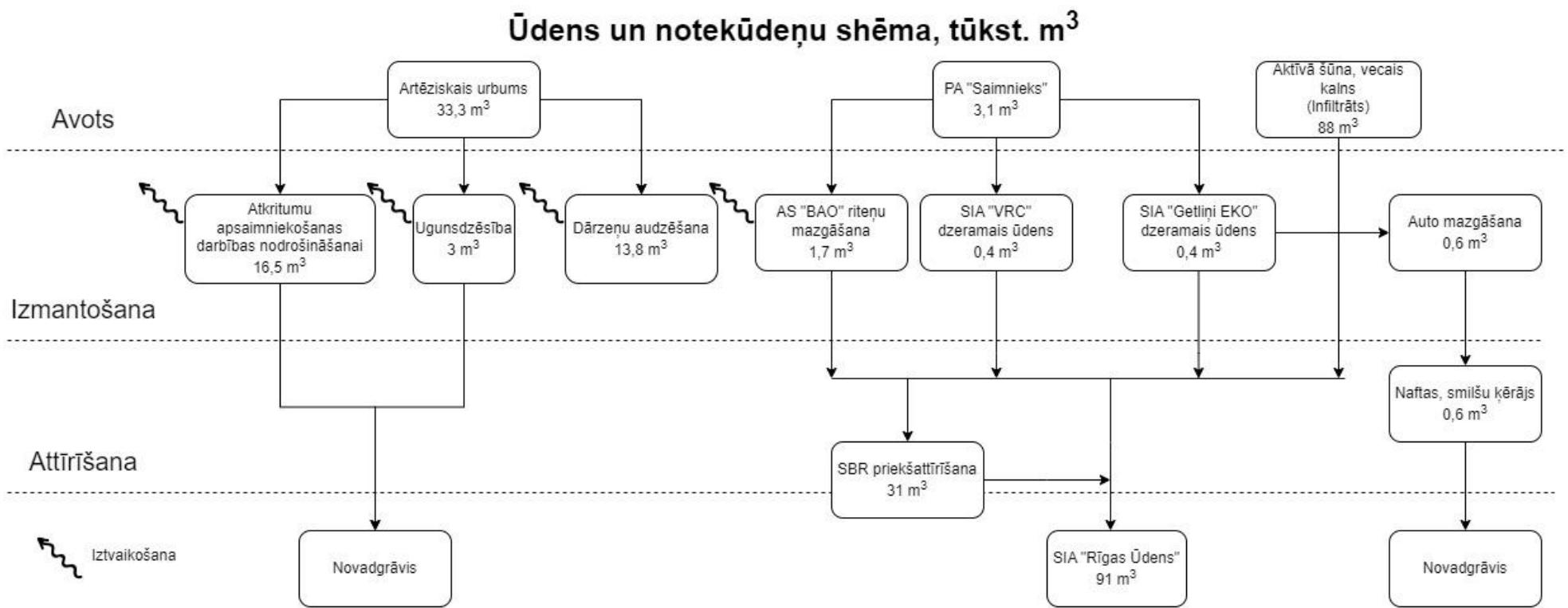
3.13. attēls. Sadzīves atkritumu poligona "Getliņi" ūdens resursu izmantošanas un notekūdeņu apsaimniekošanas sistēmas shēma
