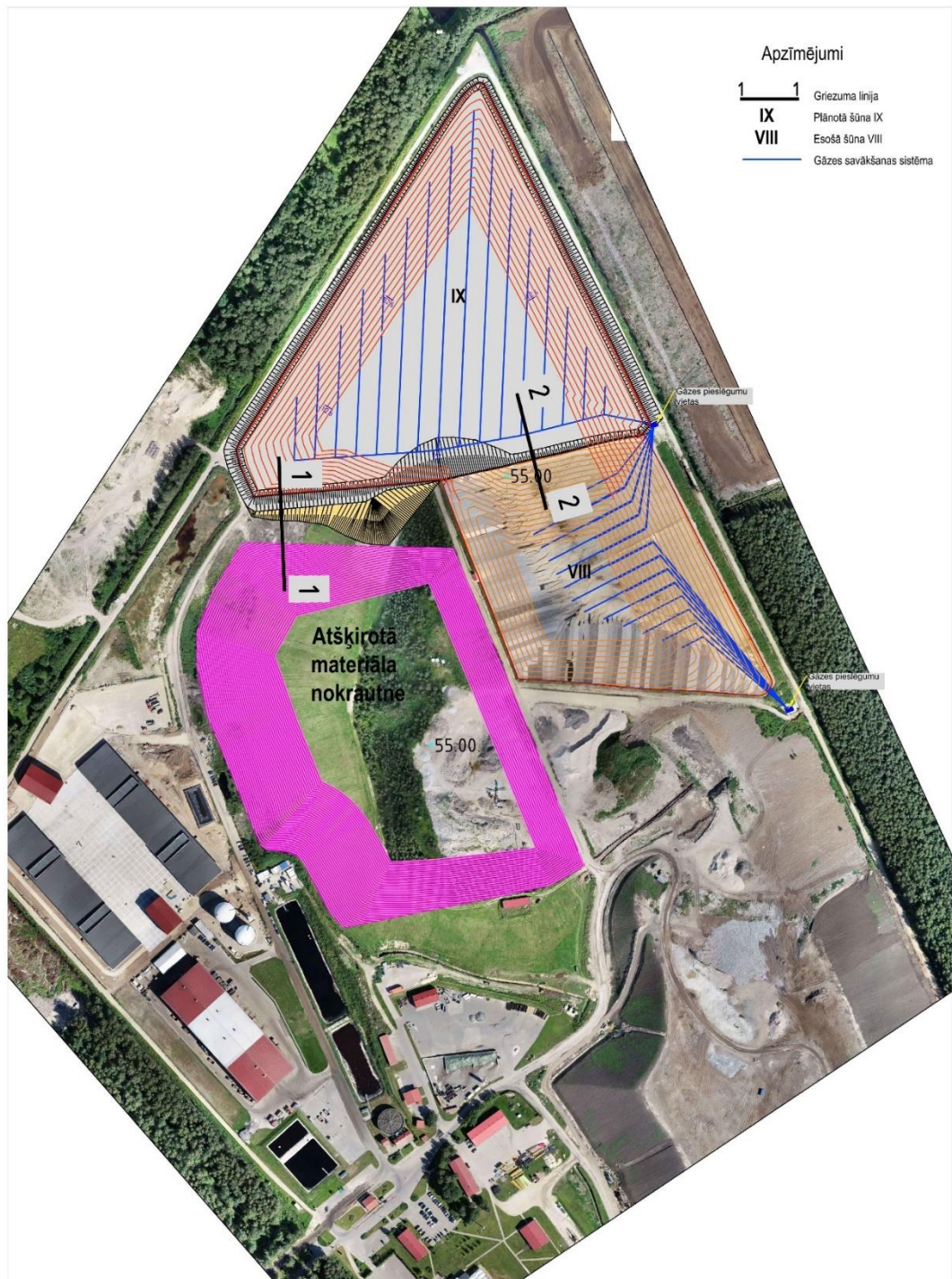
8. attēls. Būvniecības darbu 3. kārtā: Atkritumu aizpildīšana un gāzes savākšanas sistēmas izbūve šūnā Nr. IX un šūnā Nr. VIII
