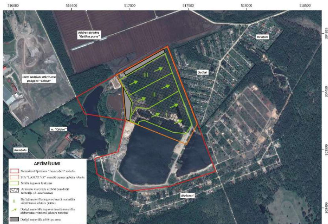
1.7.attēls. Derīgā materiāla ieguves/inertā materiāla apmaiņas tehnoloģiskais process
