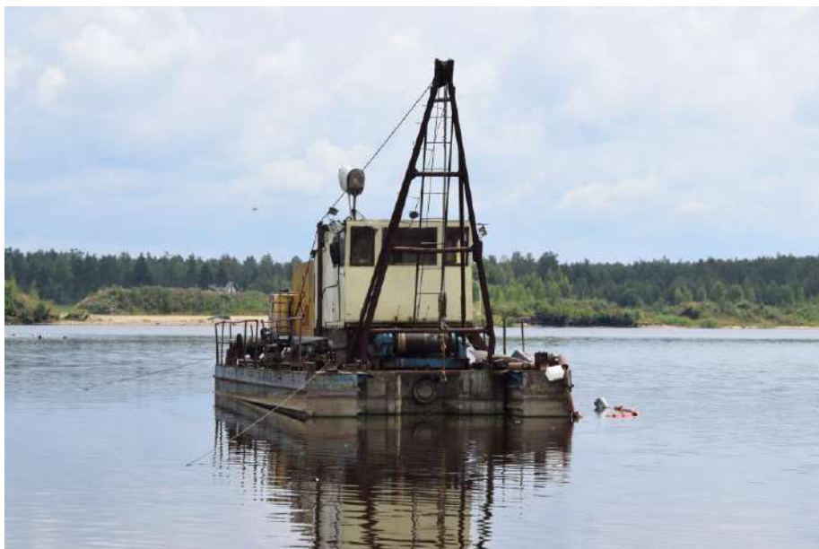
1.3.attēls. Smilts ieguvei paredzētā zemessūcēja vizualizācija
