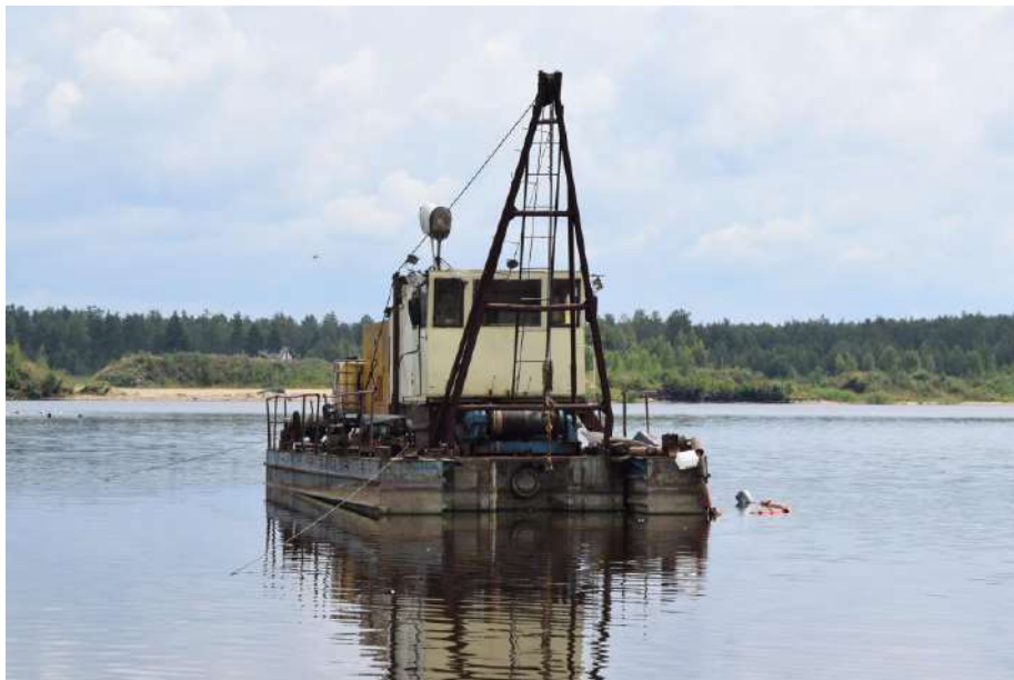
1.3.attēls. Smilts ieguvei paredzētā zemessūcēja vizualizācija
