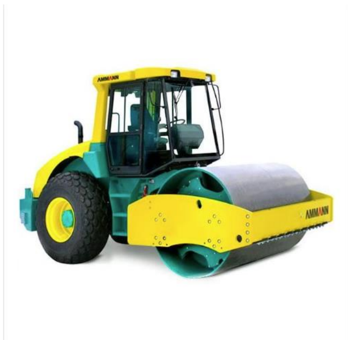
4. attēls. Vibroveltnis Ammann 12 t vai analogs (EU stage V), jauda 100 kW tiek darbināts, izmantojot dīzeļdegvielu
