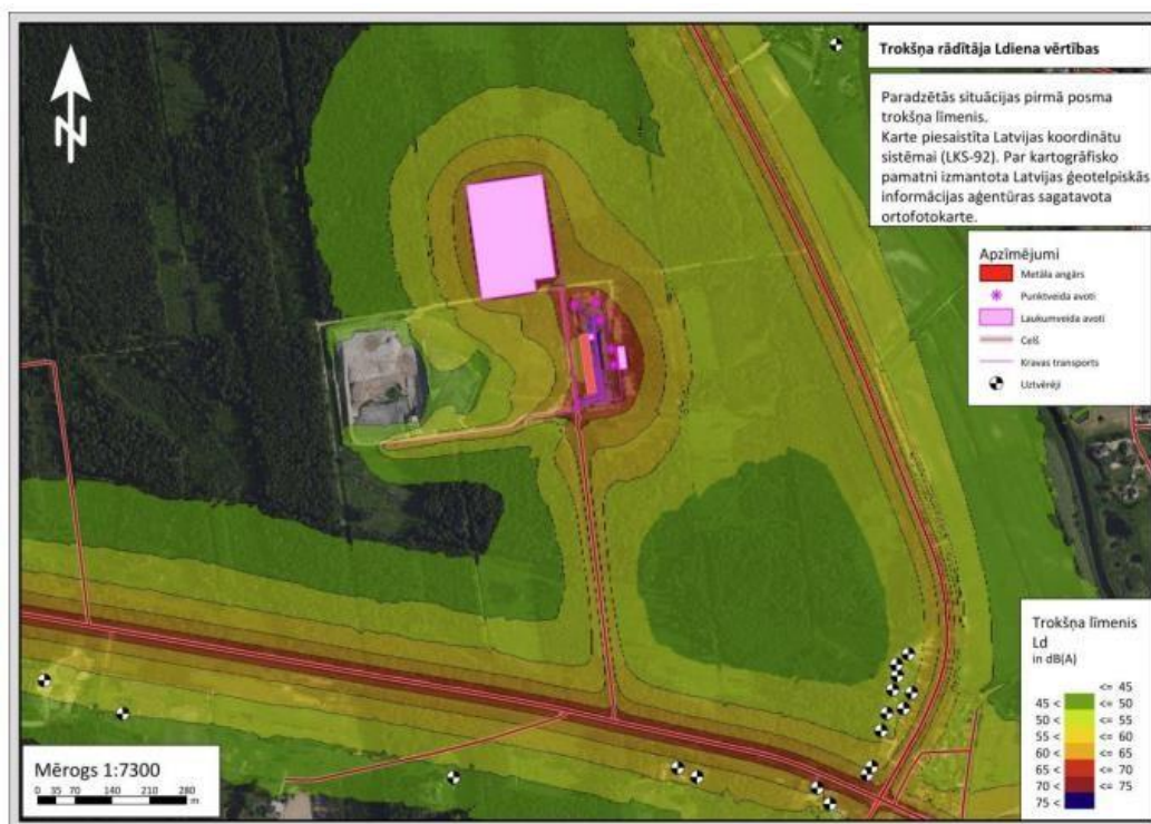
5. attēls. L d diena kopējais trokšņa līmenis sadzīves atkritumu poligona "Brakšķi" ietekmes zonā (7:00-19:00), dB(A) (avots: SIA "Vides eksperti" "Trokšņu ietekmes novērtējumu sadzīves atkritumu poligona "Brakšķi" infrastruktūras paplašināšana (jaunas atkritumu krātuves izveide) Līvērzes pagastā, Jelgavas novadā", 2023. g.)
