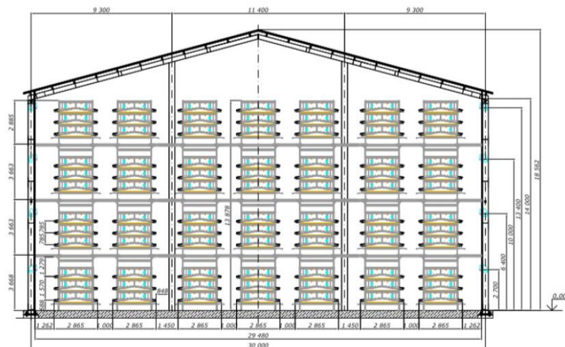
3.10. attēls. Dējējvistu turēšanas novietnes šķērsriezuma profils
