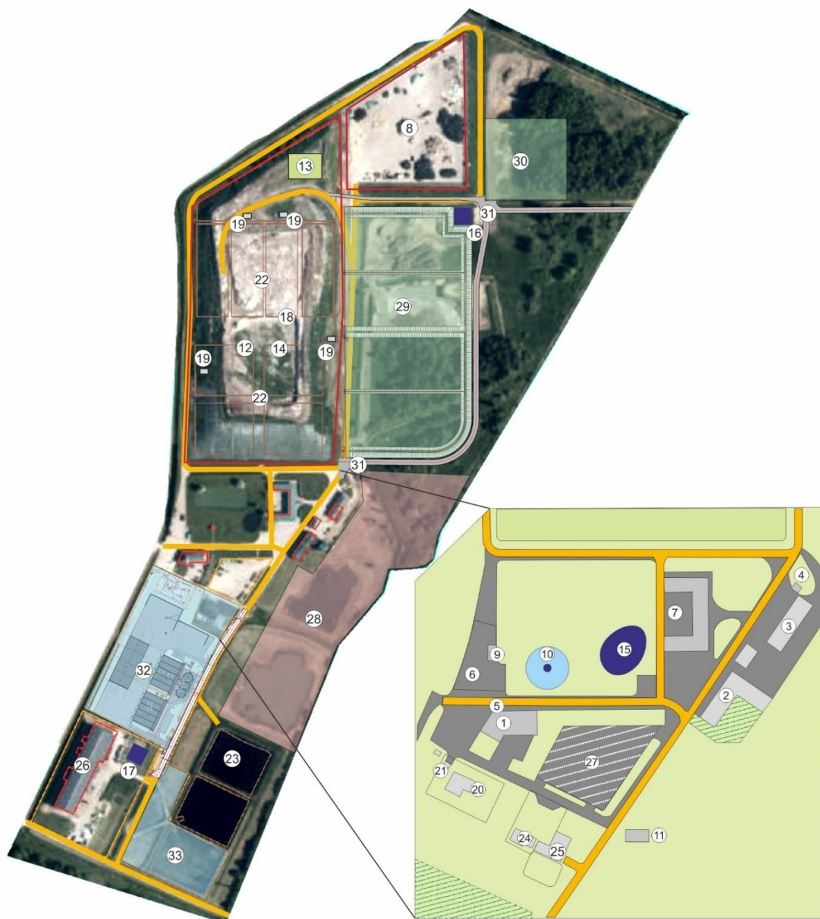
4.1. attēls. Sadzīves atkritumu poligona “Kivītes” esošo un plānoto infrastruktūras objektu izvietojuma shēma
